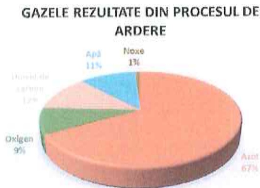
Figura 4.12. Compoziția gazelor rezultate din arderea motorinei.
